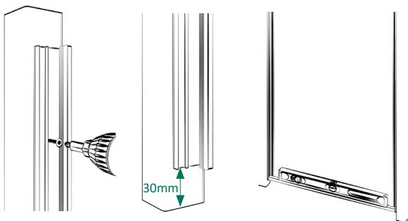
3 | Die Klemmschiene wird mittig mit einem unteren Abstand von 30 mm auf den Pfosten befestigt. Die Schraublöcher bitte mit einem 3 mm Bohrer vorbohren! Die zweite Klemmschiene am gegenüber stehenden Pfosten mit Hilfe einer Holzleiste und einer Wasserwaage befestigen.
