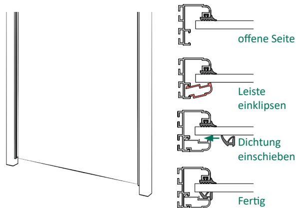
4 | Die Füllung mittig zwischen den Klemmschienen auf den Aluminium-Auflagewinkeln vorsichtig positionieren. Die Leiste mit der Rastnase in die Klemmschiene einklipsen und nach vorne schwenken, bis die vordere Rastnase einrastet. Danach die Dichtung wie dargestellt einschieben.
