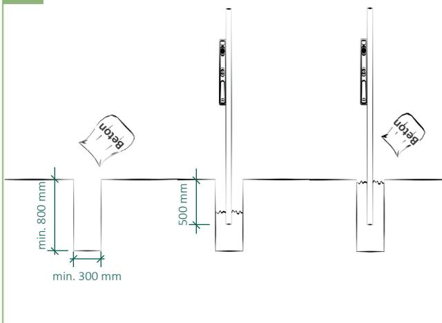
1 | Größe der Fundamente mindestens 300 x 300 x 800 mm sowie unter Berücksichtigung der Bodenbeschaffenheit.\* Ungefähr die Hälfte des Erdloches mit Beton füllen und verdichten. Anschließend die Pfosten setzen und ausrichten. Das Erdloch komplett mit Beton füllen und verdichten.
