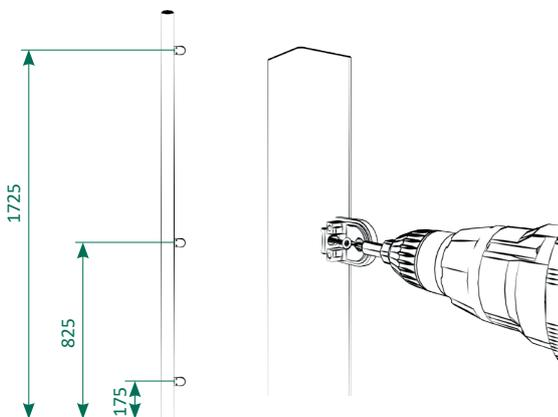
3 | Die Klemmbefestigung mit den beiliegenden Schrauben am Pfosten montieren!
