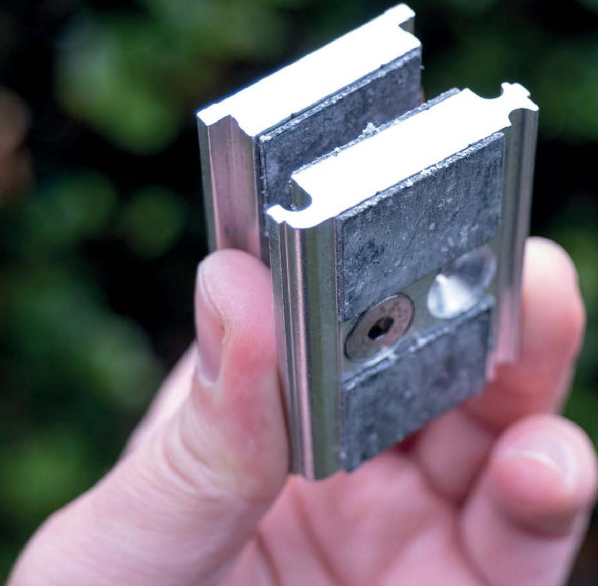
Klemmbacken in die Winkelschiene einsetzen
